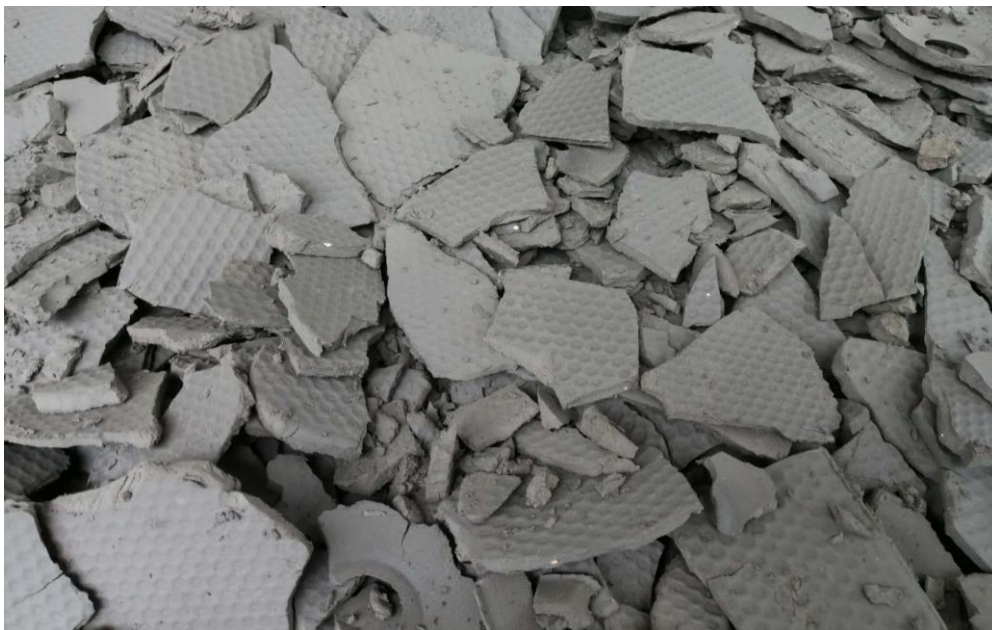
污泥淋滤深度脱水技术实物效果
